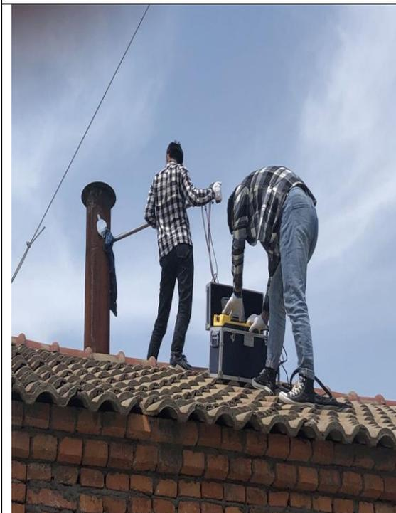
G7 锅炉废气排气筒出口监测图片
