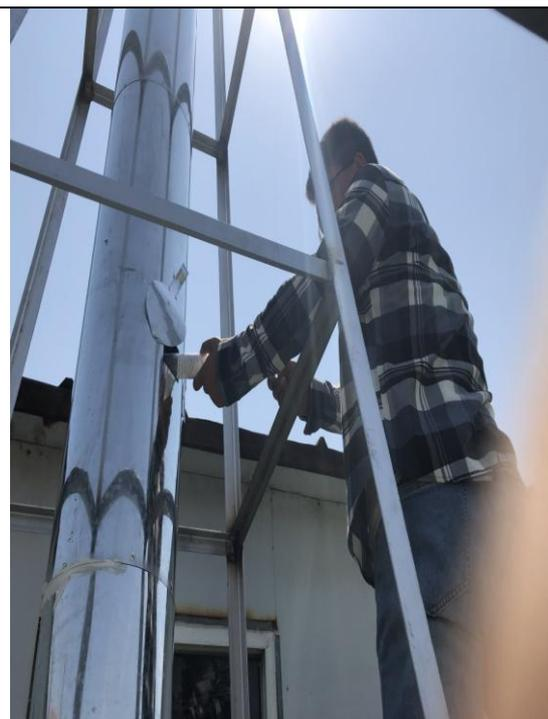
G6 定型废气排气筒出口监测图片
