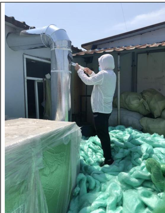
G5 定型废气排气筒进口监测图片
