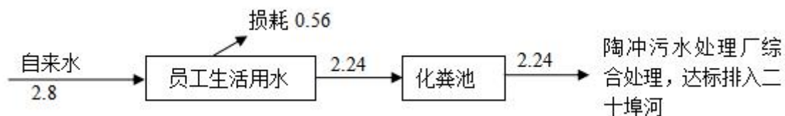
图 2-1 项目水平衡图 单位：t/d
