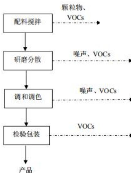
图 2-2 丙烯酸涂料生产工艺流程及产污节点图
