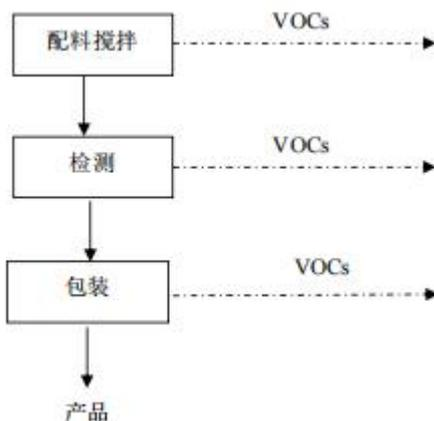
图 2-4 稀释剂生产工艺流程及产污节点图
